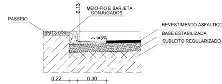
DETALHE MEIO-FIO E SARJETA CONJUGADOS SEM ESCALA
