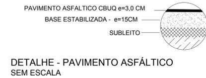
DETALHE - PAVIMENTO ASFÁLTICO SEM ESCALA
